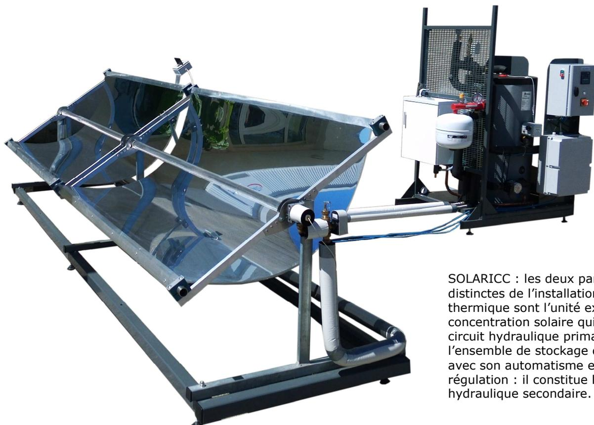
**SOLARICC est un dispositif de production d'eau chaude sanitaire par concentration solaire.**
