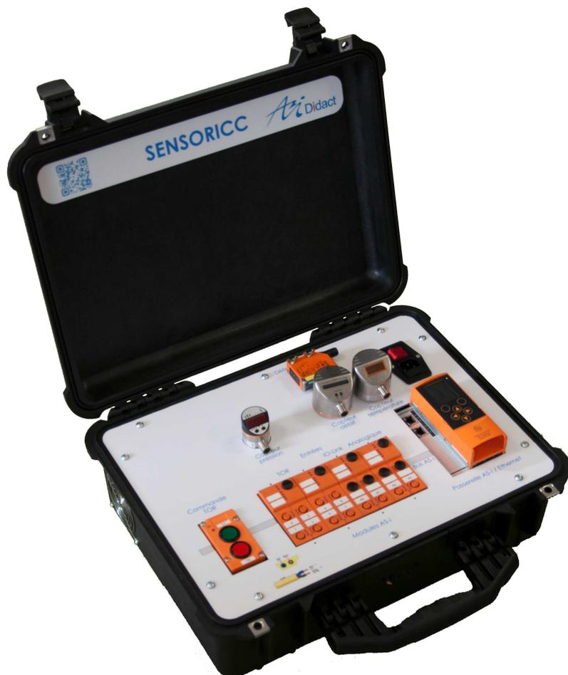
**SENSORICC est une centrale de mesures dont les valeurs, collectées par un bus de terrain sont transmises à une tablette ou à un PC via une communication industrielle sous Ethernet/IP.**
