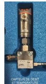
Mise en place d'un capteur de débit et température sur circuit de refroidissement de l'extrudeuse
