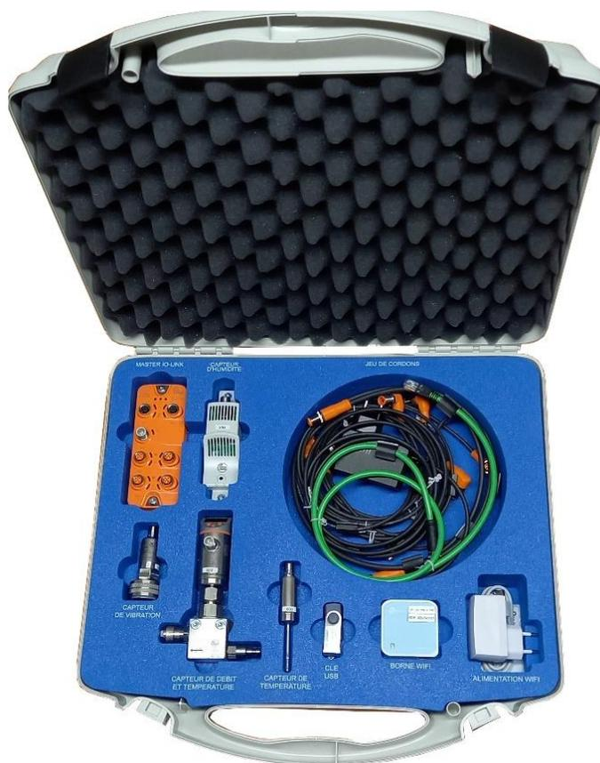
**SENSORICC-E2 est un ensemble de mesure équipé de capteurs de technologie IO-Link spécifiques au procédé de ligne de la production PRODUCTICC et, plus précisément, au système EXTRUDICC. Les valeurs numériques collectées via le protocole IO-Link sont transmises à une tablette ou à un PC par une communication industrielle sous Ethernet/IP ou en Wi-Fi.**
