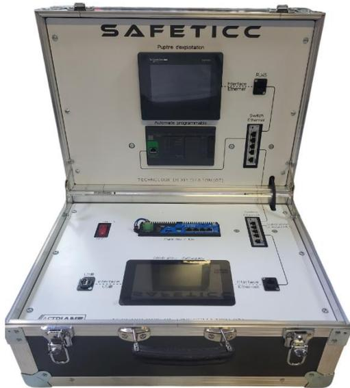
Mallette expérimentale avec sa partie opérative de convoyeur de tri (100% électrique)
