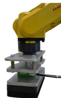
**ROBOTICC - P est un système didactisé dont l'élément central - un robot industriel 6 axes - évolue dans une application de conditionnement de produits manufacturés sur une palette bois. Ce système automatisé peut être intégré dans une ligne de production de sacs de céréales, graviers, sable, ...**
