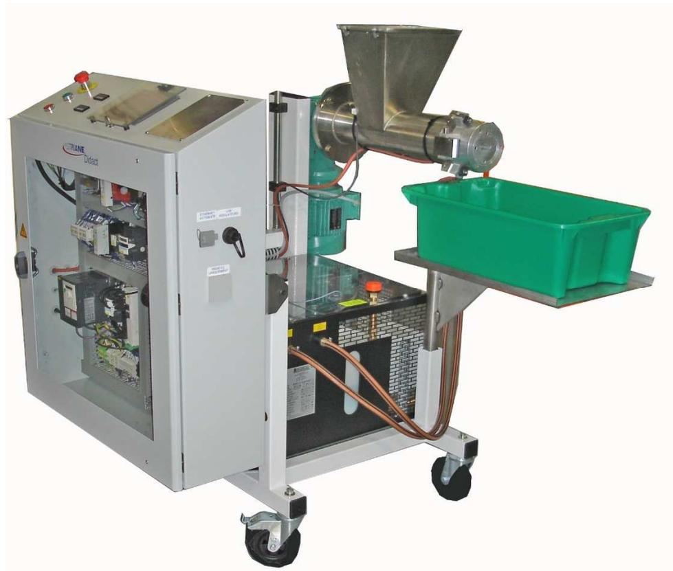
**MODULICC est un système industriel d'extrusion de produits cosmétiques issu d'ateliers de savonnerie. Il est dédié au prototypage ou à la fabrication de petites séries.**
